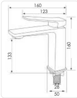
Смеситель для раковины, картридж 35мм Sedal, аэратор Neoperf, гибкая подводка
