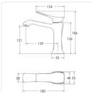
Смеситель для раковины, картридж 35мм Sedal, аэратор Neoperf, гибкая подводка
