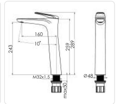
Смеситель для раковины, картридж 35мм Sedal, аэратор Neoperf, гибкая подводка
