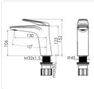
Смеситель для раковины, картридж 35мм Sedal, аэратор Neoperf, гибкая подводка
