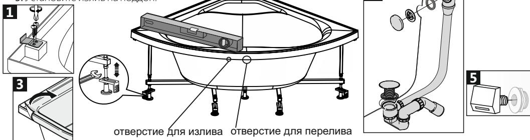
5. Установите экран, предварительно сняв с него защитную пленку и зафиксируйте его кронштейнами.
