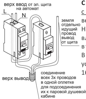
**С** – вывод электропитания для кабин с панелью управления (радио, подсветка вентиляции).
