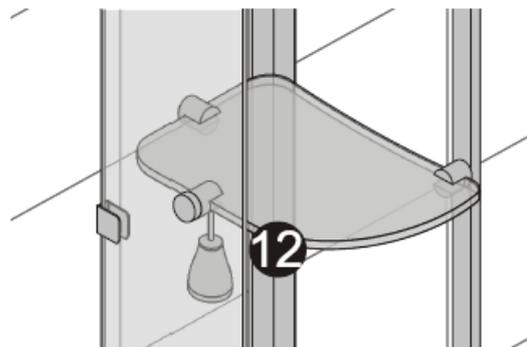
12) Используйте 3 винта ST4x30 для фиксации держателей стеклянных панелей на стене.
