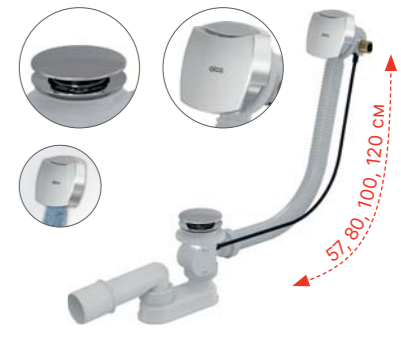
A564KM1 Сифон для ванны автомат с напуском воды через перелив, металл
