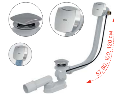
A564KM3 Сифон для ванны автомат с напуском воды через перелив, металл
